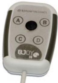
Bjoy Hand-A permet de contrôler l'ordinateur avec un léger mouvement de doigt. Personnalisable aux besoins de chaque utilisateur, ce produit est une excellente option pour les utilisateurs ayant peu de forces dans les mains (joystick analogique ultrasensible et ergonomique).
